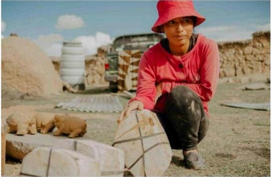
Figura 35: proceso de colada en la construcción de piezas con moldes. Espera entre la instancia de llenado y de vaciado.
