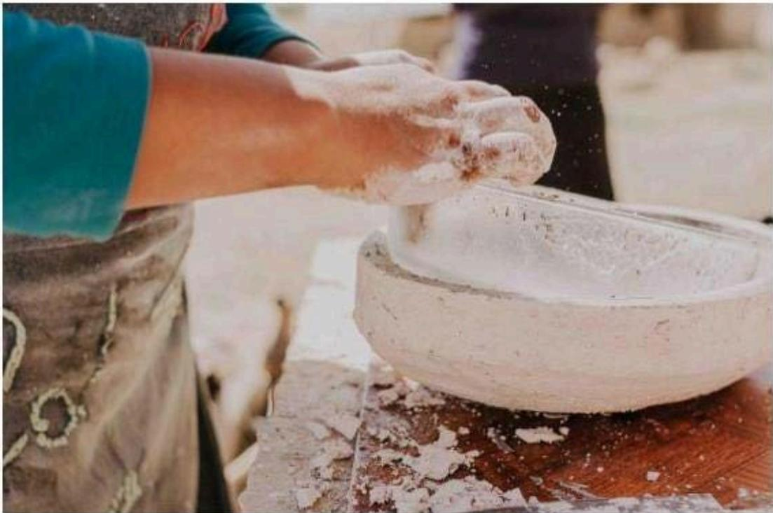
Figura 33: elaboración de moldes a partir de bandejas industriales
