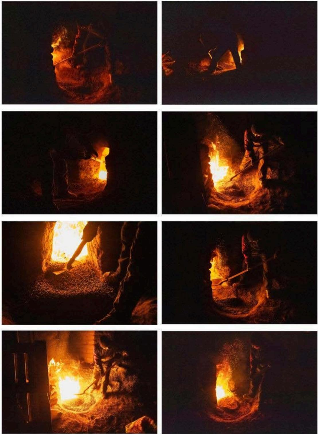
Figura 43: Cocción exclusivamente con guano en horno con cámara de alimentación
