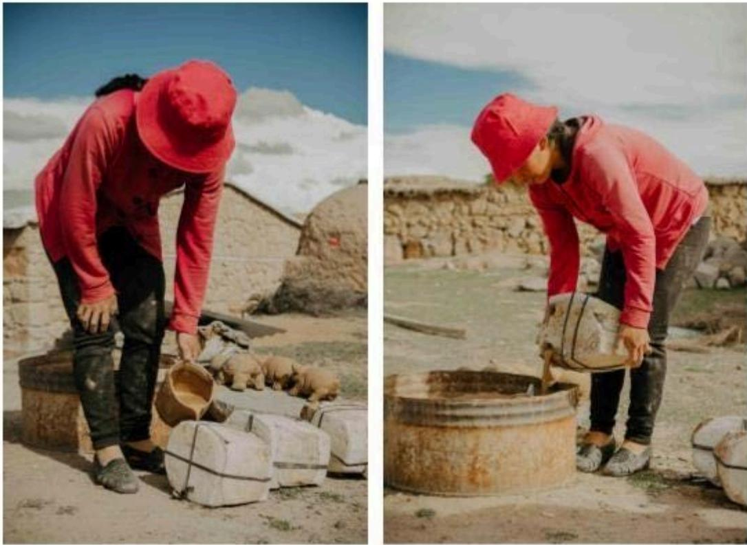
Figura 34: proceso de colada en la construcción de piezas con moldes. A la izquierda se ve el llenado y a la derecha el vaciado.
