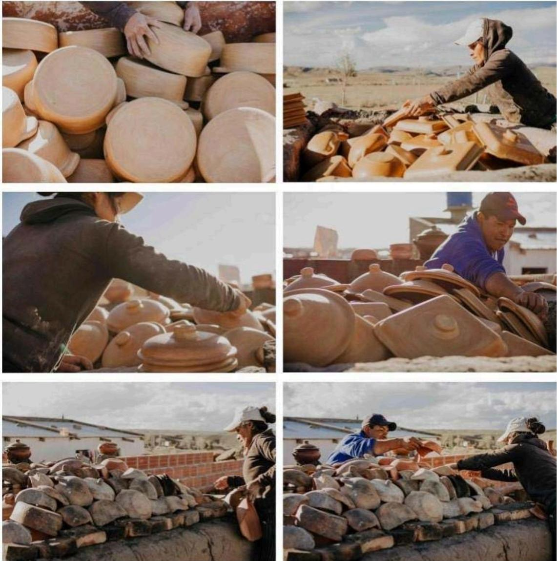
Figura 46: proceso de carga del horno con ollas con nuevas morfologías. Cocción de un encargo de gran volumen que superó el espacio interno del horno. Se coloca un borde de ladrillos para elevar la altura de las paredes y se cubre con tiestos cerámicos para conservar la temperatura.
