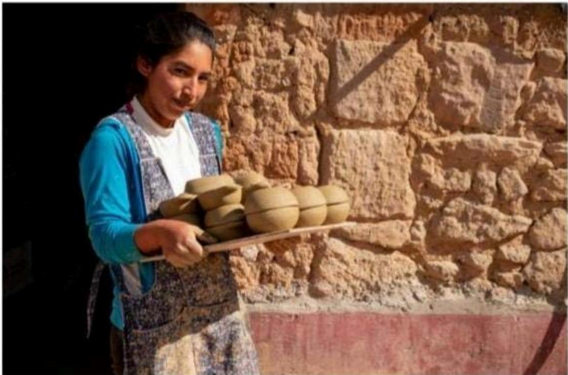
Figura 32a: traslado de las piezas al sol para su secado
