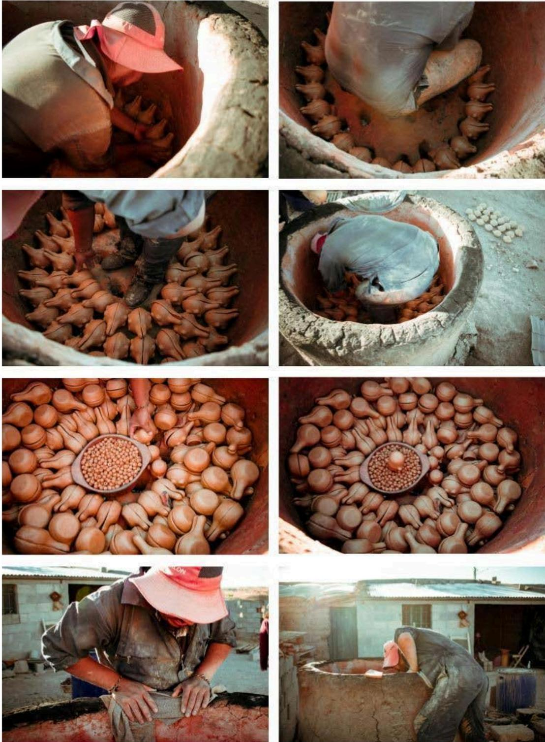
Figura 45a: proceso de carga del horno con piezas pequeñas
