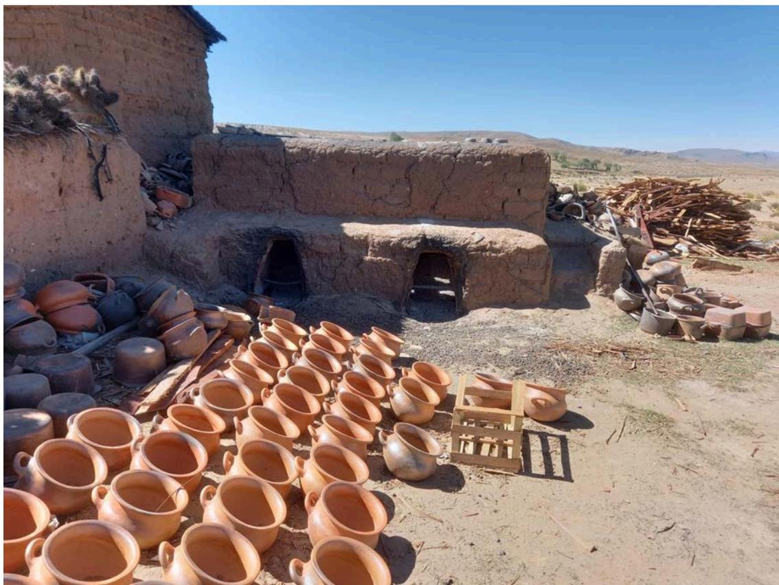
Figura 44: Horno de producción a gran escala con doble boca de alimentación
