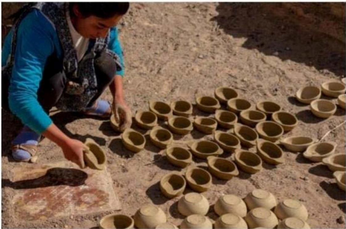
Figura 32b: traslado de las piezas al sol para su secado
